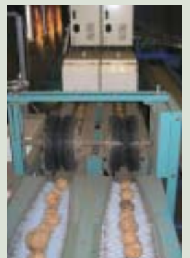
1個ずつセンサーを通し、内部をチェックしてから出荷しています
